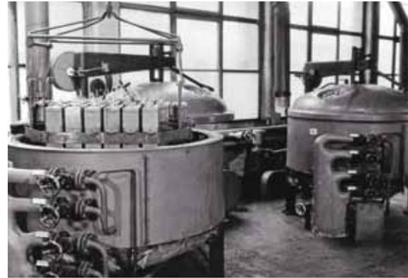
Vakuunkessel für die Öl-Imprägnierung von Papierkondensatoren.
