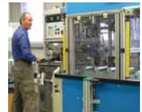
Auch die Endprüfanlage für Leistungskondensatoren aus den frühen 1990er Jahren wurde deutlich aufgerüstet und um eine Station zur Dichtheitsprüfung gasgefüllter Kondensatoren ergänzt.
