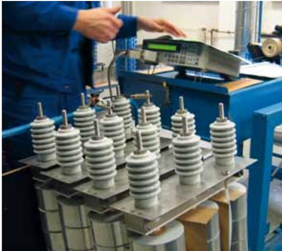
Äußerlich ähneln sie den herkömmlichen Mittelspannungskondensatoren der Wettbewerber. Innen sind sie jedoch ganz anders: trockene MSD-Kondensatoren mit Rundwickeln aus selbstheilender Folie.
