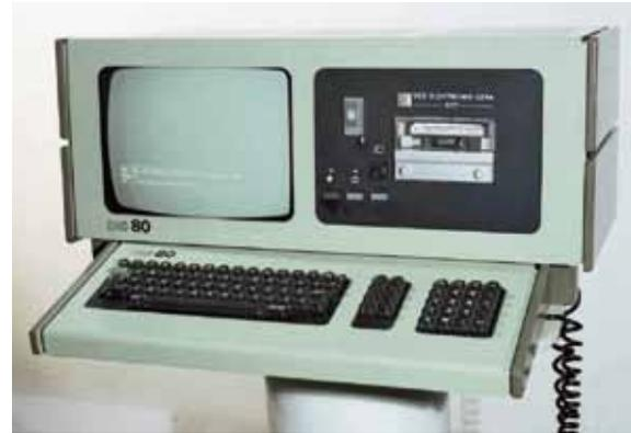
Der Microcomputer MC80; sein Magnetband-Massenspeicher nutzte die Topologie des Geracord; der Preis lag bei ca. 29.000 Mark.
