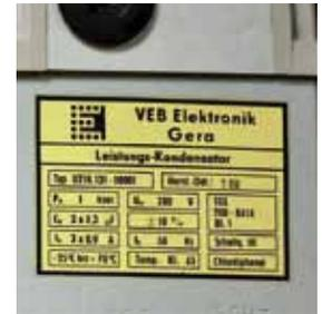
Seit 1977 läuft die gesamte Produktion mit neuem Logo. Ein wachsender Anteil des Sortimentes Wickelkondensatoren wird bereits ohne PCB-haltige Imprägniermittel gefertigt, doch noch sind gerade die großen Leistungskondensatoren mit Chlordiphenyl gefüllt.
