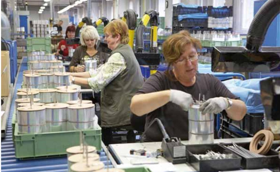
Kurze Wickel mit großem Durchmesser, das Grundprinzip des ELECTRONICONSchen Designs für hohe Strombelastungen.
