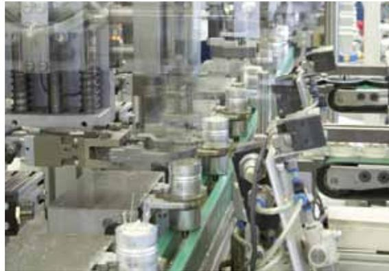
Die Somatic-Linie erledigt in einem Zug die gesamte Montage von Metallbecher-Kondensatoren einschließlich der integrierten Überdrucksicherung.
