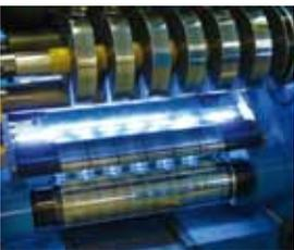
Mit ELECTRONICON's SineCUT-Wellenschnitttechnik wird die Stromtragfähigkeit der Wickel weiter gesteigert.
