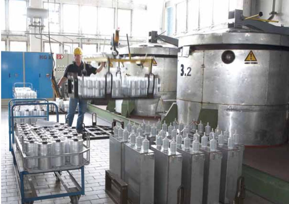
Alte Kessel mit neuer Funktion: Die noch aus den 70er Jahren stammenden Imprägnierkessel wurden, generalüberholt und mit neuer Steuerung ausgestattet, zu Vakuum-Trockenkesseln umfunktioniert.
