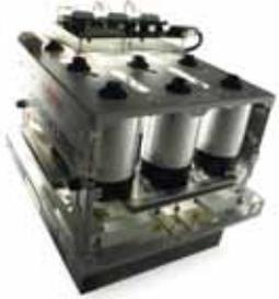
Der Aha-Effekt: Im Umrichter-Stack „Semikube“ (oben) des innovativen Halbleiterspezialisten Semikron gelang mit den neuen PK16 von ELECTRONICON die Ablösung von Elektrolytkondensatoren (unten) in gleichem Volumen. Der Semikube revolutionierte die Branche.
